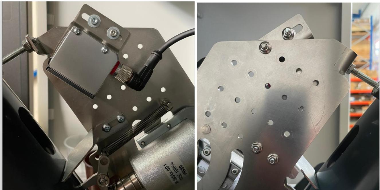
Der 3Polige Stecker vom Farbsensor wird zwischen den beiden anderen 3Poligen Steckern eingesteckt.
